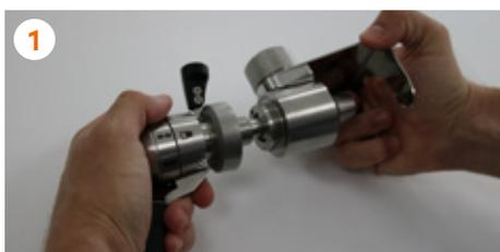
1 Nous démontons la partie supérieure du robinet en tournant l'élément vissé et en suivant les étapes de nettoyage indiquées précédemment.
