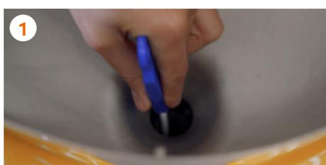
1 Introduisez la brosse de nettoyage dans l'orifice **Drain&Clean** à la base du chargeur en éliminant les déchets présents dans le tube.
