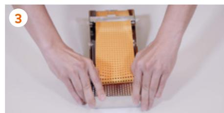
3 Retournez l'ensemble et positionnez les doigts sur le **rouleau de la bande transporteuse** en poussant vers l'extérieur pour le libérer.
