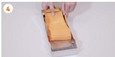
4 Retirez la **bande transporteuse** avec l'autre rouleau et retirez les deux pièces.
