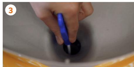
3 Introduisez la brosse de nettoyage dans l'orifice **Drain&Clean** à la base du chargeur en éliminant les déchets présents dans le tube.
